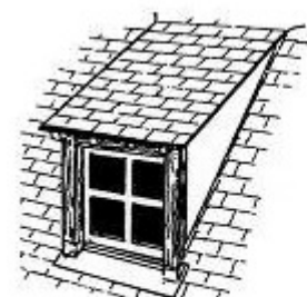
lucarne rampante ou en chien couché
